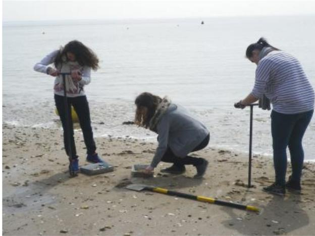
← Le forage est utilisé pour récolter un sédiment du sous-sol pour pouvoir ensuite l'analyser.
